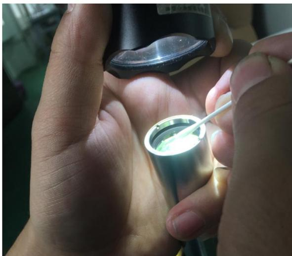
图 3 例：无尘棉签清洁锐科 QCS 跳线头手法
