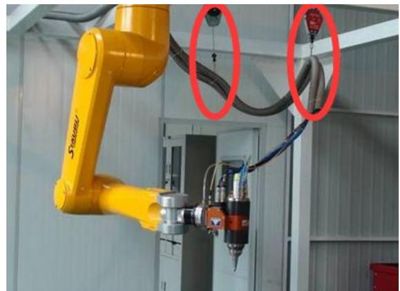
在光纤线缆外部可以加有一定抗弯折能力的防护套管，然后采用挂吊的方式牵引到切割头附近（使用“弹簧平衡器”如下图）。
